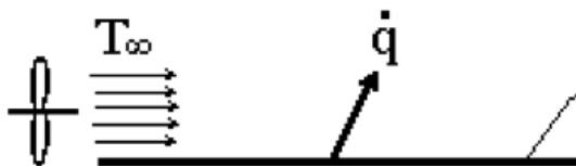
Figura 3. Transferência de calor, forçada, da superfície para o ar.
